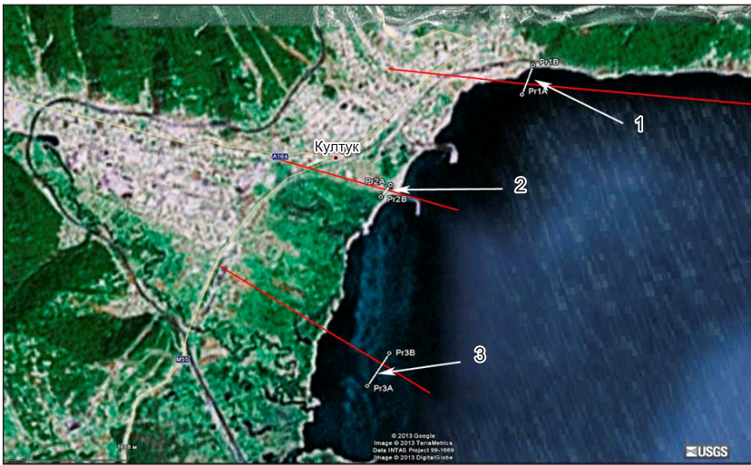
Рис. 10. Схема расположения профилей в районе поселка Култук. Красными линиями отмечены линии разломов земной коры, отрезками белых линий с номерами – профили 1–3, пересекающие разломы.
