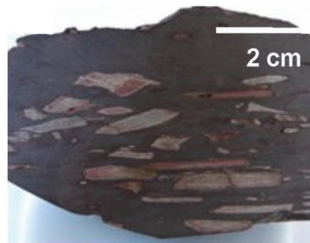
Рис. 4. Гематитовая микробрекчия в железной руде [Figure 4. Hematite microbreccias in iron ore]
