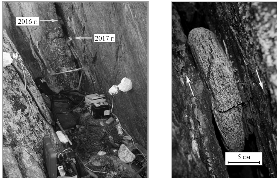
Рис. 7. Организация измерительного полигона на участке зоны Приморского рифтогенного сброса для мониторинга деформаций и сейсмической активности, а также проведения локальных воздействий с применением домкратов и слабых кумулятивных взрывов. Справа показана искусственная шероховатость (туф гранито-гнейса, вставленный в раздвинутую домкратом трещину), разрушенная в результате проведенных техногенных воздействий
