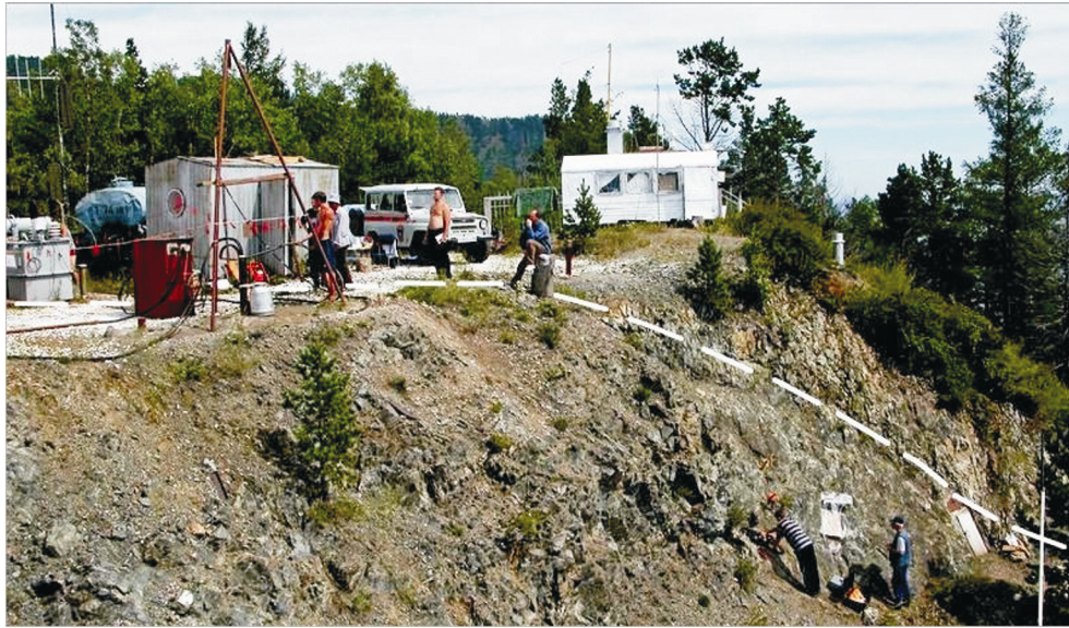
Рис. 2. Испытательный полигон в пос. Листвянка, на котором проводились многолетние наблюдения и эксперименты с воздействиями на фрагмент Ангарского разлома (серии ударов тяжелым копром, закачки воды через скважины в сочетании с внутрискважинными слабыми взрывами). Пунктиром отмечена траектория плоскости сегмента разлома (цветной в онлайн-версии)
