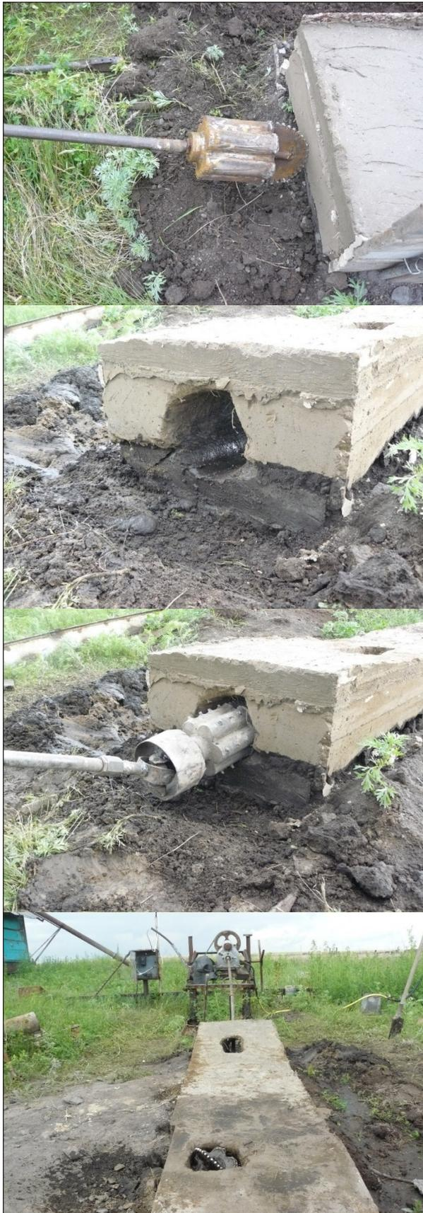
Рис. 11. Моделирование «поведения» породоразрушающего инструмента (долота) на границе пластов с различной прочностью
