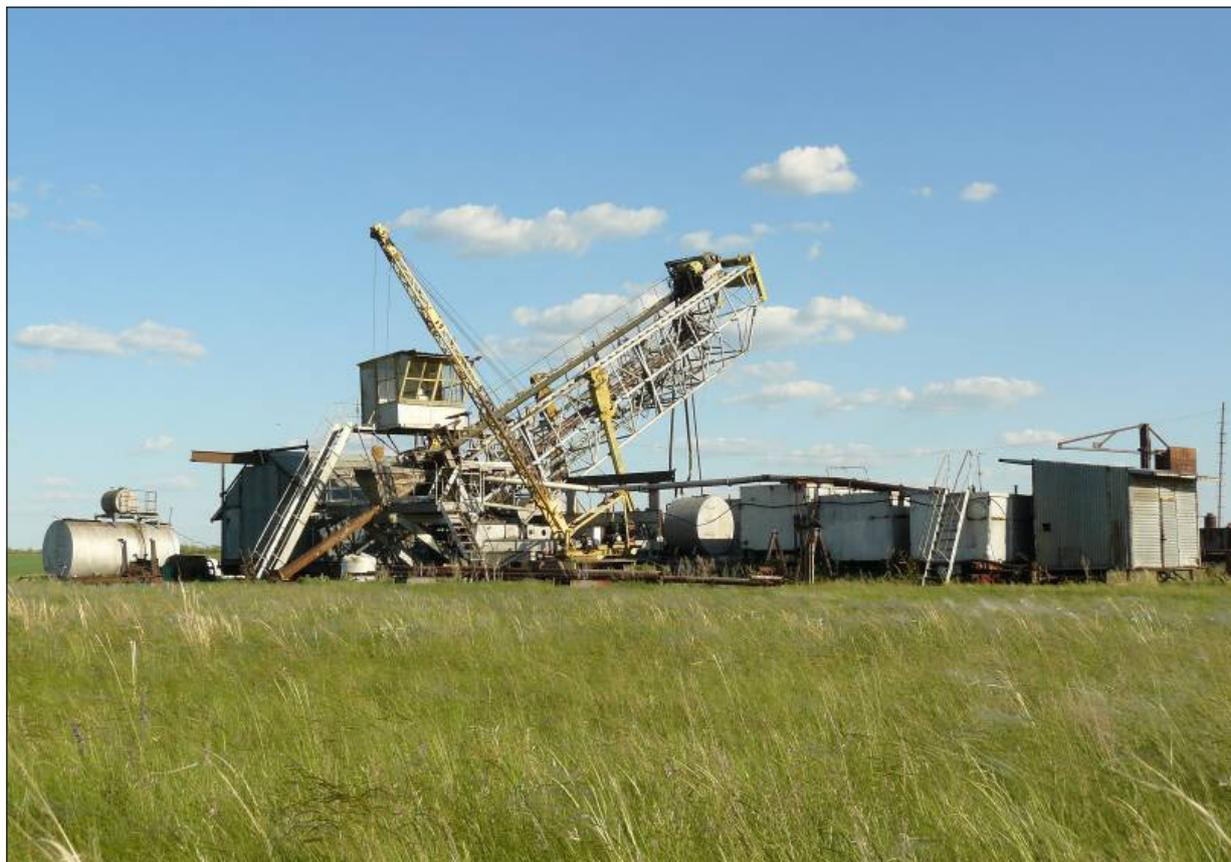
Рис. 8. Экспериментальная буровая добывающая установка (УДТИ-20)
