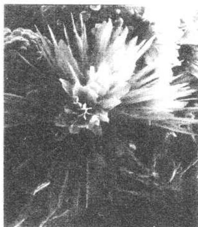
Рис. 2. Точилинит на сферолитовом кальците. РЭММА-202М, поле зрения 0,2 мм.
