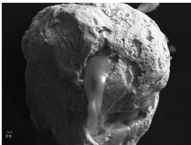
Рис. 2. Сфероид самородного золота с включением графита
