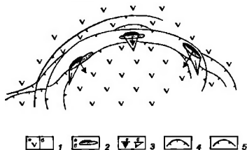
Рис. 4.7. Принципиальная схема соотношения направлений падения тел габбро-верлитов и склонений рудных тел в пределах Печенгского рудного поля
