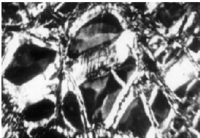
Рис. 2. Апогарцбургитовый \beta -лизардитовый серпентинит мелкопетельчатой зональной секториальной структуры. Секториальные низкодвупреломляющие ячейки \beta -лизардита в окружении шнуров \beta -лизардита с шовными шнурами хризотила с магнетитом.
