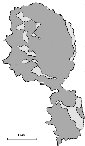
Рис. 3. Типичная форма «нодуля». Сростания галенита (светло-серый) и халькопирита (темно-серый) субграфические. Зарисовка с полированного шлифа.
