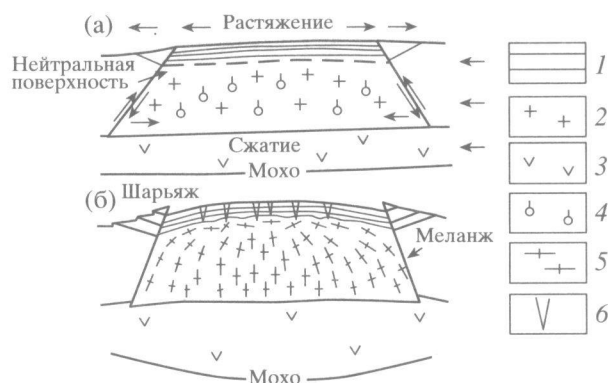
Рис. 1. Схема развития положительного изгиба на коре повышенной мощности при пониженных скоростях деформации. а – начальная стадия; б – конечный результат. 1, 2 – верхняя кора (1 – осадочный чехол, 2 – кристаллический фундамент); 3 – нижняя кора; 4 – высокотемпературный метаморфизм и дегазация; 5 – гранито-гнейсы, гранулиты, эклогиты; 6 – диатремы и дайки эруптивных брекчий.
