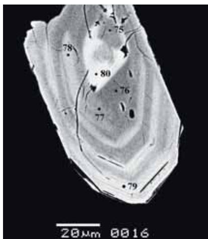
Рис. 10. Сложно зональный кристалл циркона. Цифрами показаны места анализов, приведенных в таблице 10. В отражённых электронах.
