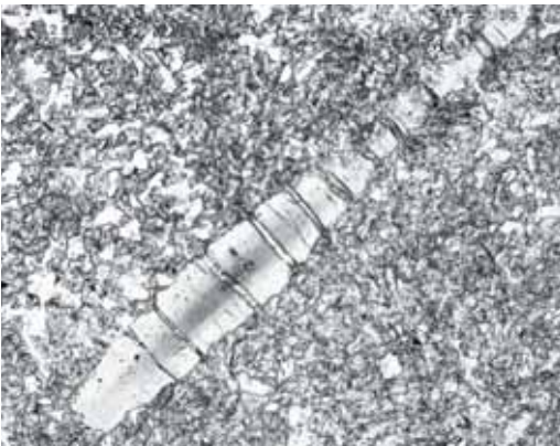
Рис. 5. Длиннопризматический кристалл зонального турмалина – гравита в флогопит-магнезитовой матрице. Кристалл деформирован, трещины отдельности заполнил доломит. В проходящем свете: а – при 1 никеле, б – николи х.
