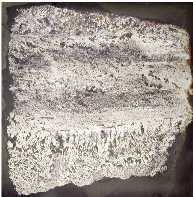
Рис. 1. Полированный рудный штуф с полосчатой (зональной) текстурой из подводных колчеданов (6° с.ш. ВТП). В более темных зонах концентрируются оксиды, в светлых — пирит; в краевой нижней наиболее крупнокристаллической зоне — ветвистые сростки пирита. Размер штуфа 2 x 2 см. В отраженном свете.
