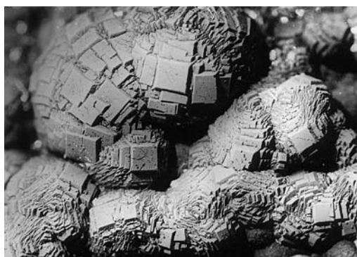
Рис.5. Переход расщепленного кубооктаэдра пирита в сферокристалл : антискелетные формы а начальная стадия образования шара. Фото напыленного оксидом магния образца на приборе ФМН-2(ЛОМО). Увеличение \times 10
