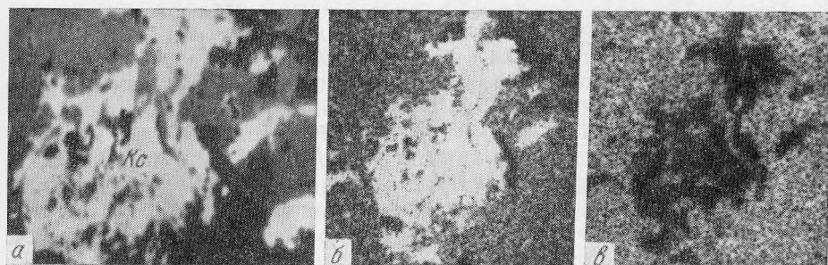
Рис. 1. Включение кальсилита в нефелине. Сканирование в поглощенных электронах (а) и рентгеновских лучах K_{K\alpha} (б), Na_{K\alpha} (в). Поле зрения 200 \times 200 мкм
