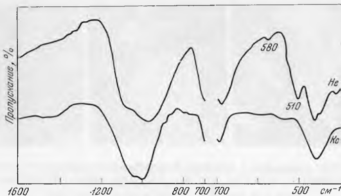
Рис. 3. ИК-спектры нефелина (He) — образец из блоковой апатитнефелиновой породы Кукисвумчорра, Хибин (материал М. Н. Соколовой) и кальсилита (Kc) — образец из Мурманского массива (материал Н. С. Самсоновой)
