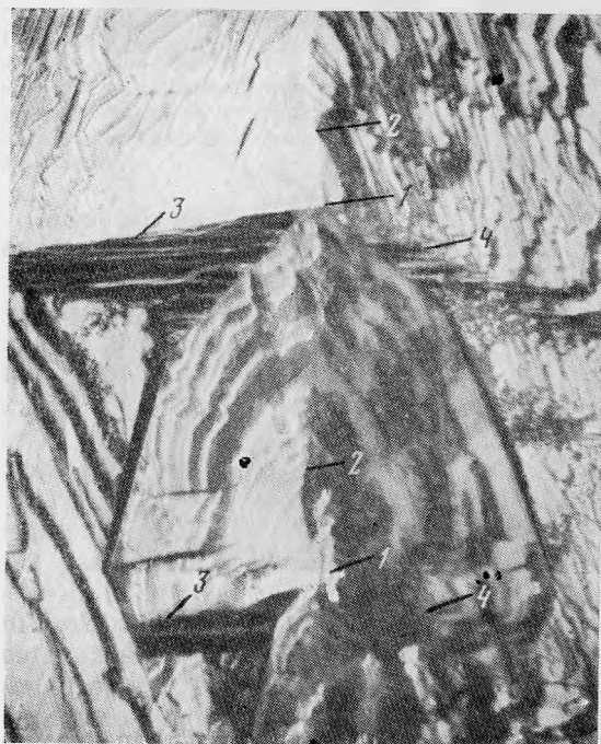
Рис. 7. Вициналъ на грани R кварца, имеющая симметричное строение. Увел. 10 1 — вершина; 2 — 4 ребра вицинали
