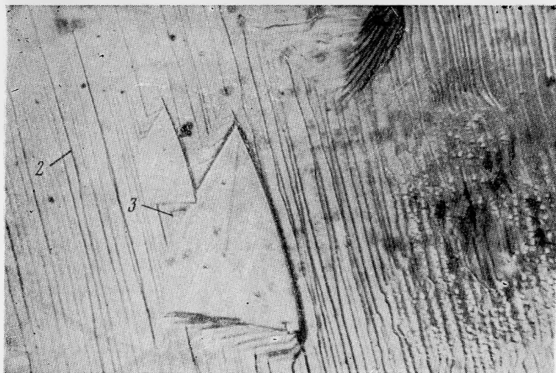
Рис. 6. Вициналъ на грани R кварца с вершиной, смещенной влево. Увел. 10 1 — вершина; 2 — ступеньки роста; 3 — отрицательная форма роста
