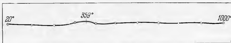
Рис. 7. Дифференциальная кривая нагревания флюоцерита
