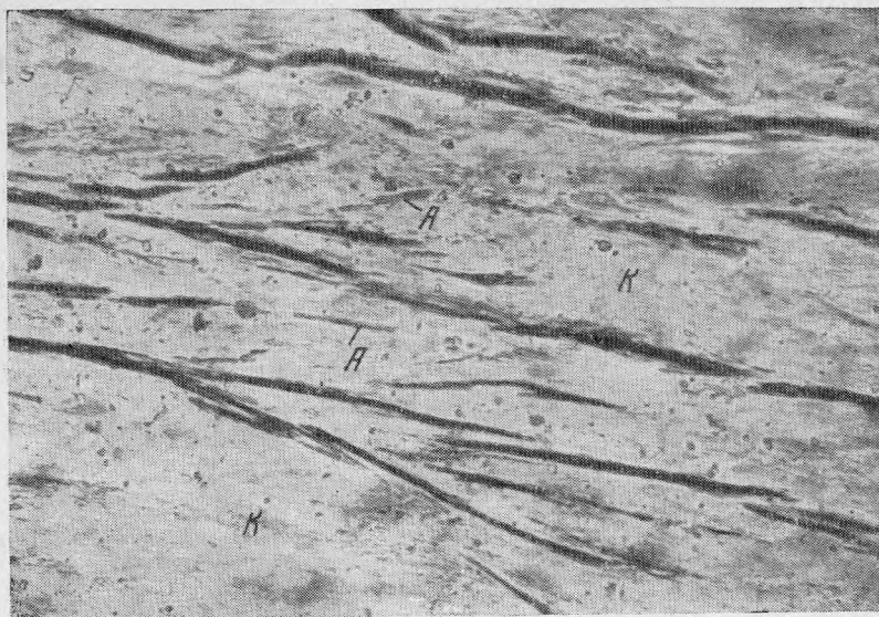
Рис. 3. Игольчатые включения афвиллита А в ксонотлите К. Без анализатора. Увел. 360
