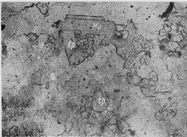
Рис. 1. Мусковитово-кварцевый грейзен, в котором мусковит (Mu) и кварц (Q) замещаются топазом (tp).  $\times 46$ , без анализатора
