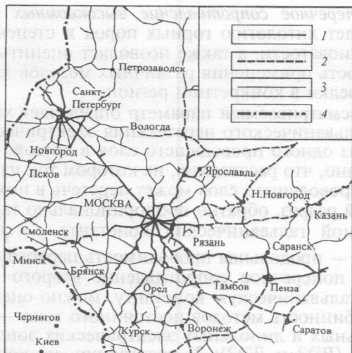
Рис. 1. Схема железных дорог Центральной России: 1—3 — железные дороги: 1 — постоянного тока, 2 — переменного тока, 3 — не электрифицированные; 4 — граница России.
