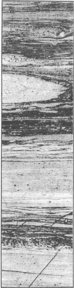
Рис. 1. Микрофотография поверхности аншлафа донецкого антрацита после ионного травления. Темно-серые слои — микстинит. Ув. 100
