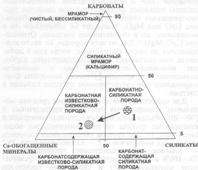
Рис. 1. Диагностическая диаграмма метакarbonатных и ассоциированных с ними метаморфических пород. Карбонаты: кальцит, доломит, арагонит; Са-обогащенные минералы: плагиоклаз, скаполит, волластонит, клинопироксен, гроссуляр, везувиян, цоизит, пумпеллиит, пренит, ломонтит, лавсонит; силикаты: кварц, оливин, ортопироксен, амфибол, слюды, хлорит, тальк; породы включают структурные вариации: сланец и гнейс, в соответствии с наблюдаемой сланцеватостью или планарной ориентировкой пластинчатых минералов. Цифрами обозначены: мусковит-хлорит-карбонатный сланец (1), при прогрессивном метаморфизме превращенный в карбонат-цоизит-клинопироксеновую известково-силикатную породу (2) (по [20])
