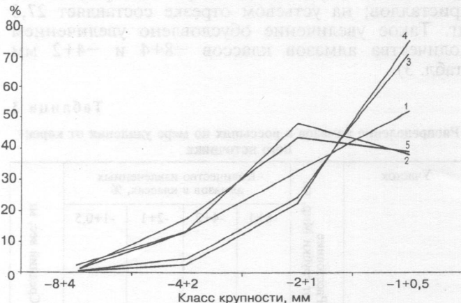
Рис. 2. Распределение алмазов в россыпях ближнего переноса: 1 — р. Ирелях ниже трубки Мир; 2 — Водораздельные галечники (J 1 ), трубка Мир; 3 — делювиально-пролювиальная, дяхтарская свита (T 3 -J 1 ), трубка Нюрбинская; 4 — делювиально-пролювиальная (укугутская свита, J 1 ), трубка Нюрбинская; 5 — Новинка (J 1 ), трубка Интернациональная
