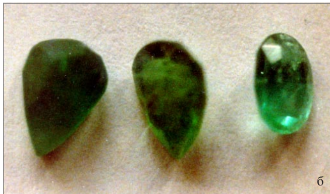
Рис. 3. Изменение окраски бразильских ограненных изумрудов: а — исчезновение голубого оттенка и усиление зеленой окраски (73 МэВ, 400 имп.), б — усиление зеленой окраски (контрольный образец справа, в середине облученный, слева — дважды облученный)
