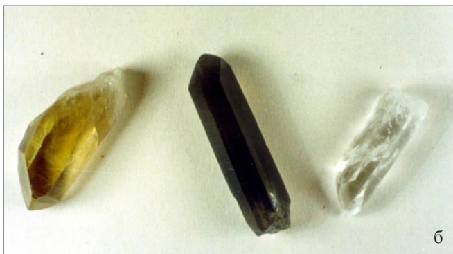
Рис. 4. Изменение окраски минералов: а — осветление и повышение степени прозрачности ограненного сапфира (контрольный образец справа), б — изменение окраски прозрачного кварца (в середине — раухтопаз, слева — цитрин).
