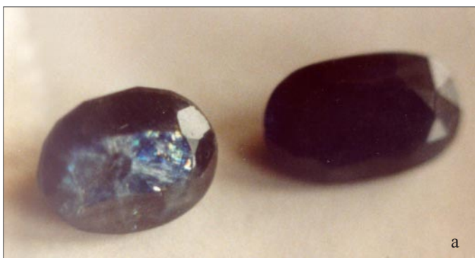
Рис. 4. Изменение окраски минералов: а — осветление и повышение степени прозрачности ограненного сапфира (контрольный образец справа), б — изменение окраски прозрачного кварца (в середине — раухтопаз, слева — цитрин).
