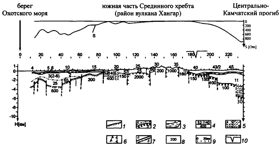
Рис. 22. Геозлектроический разрез верхней части земной коры по профилю пос. Нижняя Облуковина – г. Адриановка, по: [Нурмухамедов, 2001], с сокращениями
