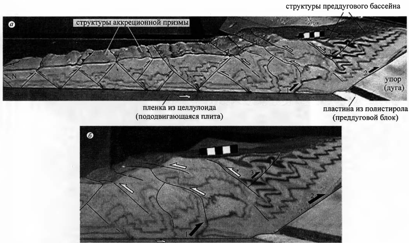
Рис. 73. Фотографии разреза модели (а) и его фрагмента (б) после завершения эксперимента
