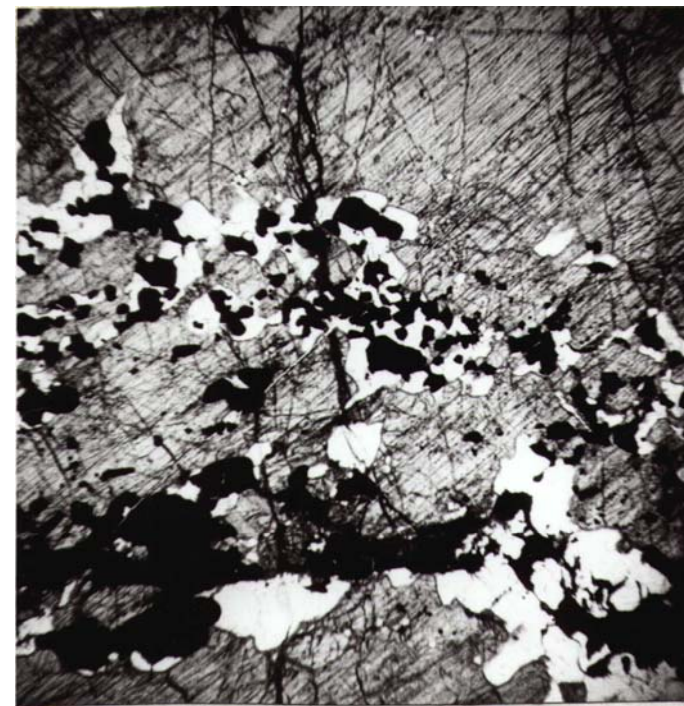
Рис. 22. Замещение крупного зерна гиперстена тонкозернистым агрегатом кварца и магнетита по секущим субпараллельным зонкам, Лысогорский участок, скв. 34, гл. 125,5 м, увел. 16 [178].
