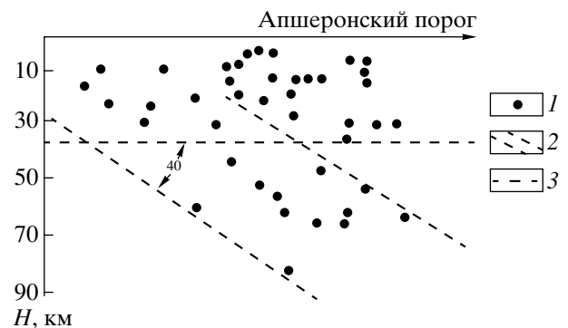
Рис. 4. Сейсмологический профиль, данный в работе [2]: 1 – гипоцентры землетрясений, произошедших до 1985 г.; 2 – зона Беньофа; 3 – усредненная поверхность Мохо.
