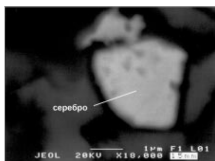
Рис. 2. Минералы золота, палладия и меди в медно-золото-палладиевых рудах проявления Озерного. Изображение в режиме обратнорассеянных электронов
