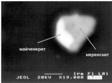
Рис. 3. Мелкие зерна минералов Pd, Te и Bi в медно-золото-палладиевых рудах проявления Озерного. Изображение в режиме обратнорассеянных электронов
