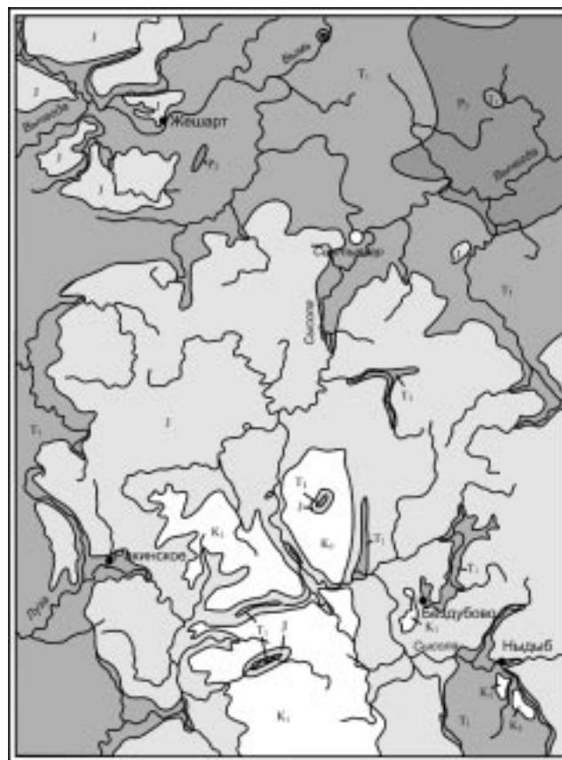
Рис. 1. Геологическая карта-схема размещения мезозойских отложений в районе Сысольского свода: 1 — меловая система (K1); 2 — юрская система (J2-3); 3 — триасовая система (T1); 4 — пермская система (P2) [4]
