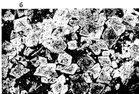
Рис. 2. Фотографии шлифов карбонатных пород тульского горизонта.
