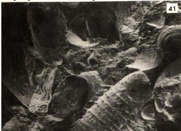
Электронно-микроскопическое строение микроракушняковых фосфоритов Дзабханской зоны (томотский уровень фосфатизации). СЭМ. Ув. 170<sup>x</sup> и 500<sup>x</sup>
