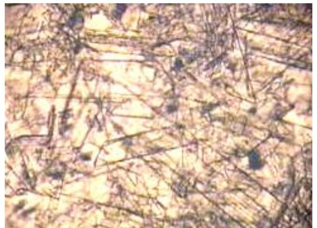
Рис.4.1.2.6. Кристаллы гипса размером 0,5мм. Иммерсия,Ник.П,Ув.60<sup>x</sup>.
