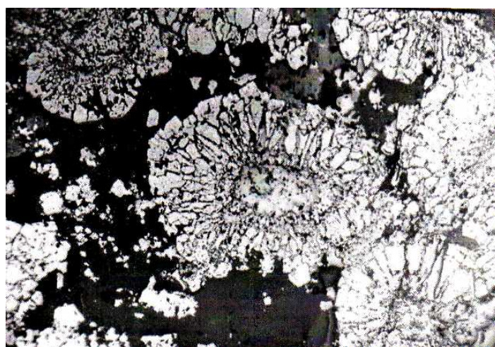
Рис. 6.4. Халькопирит-пиритовые оолитовые обособления. Талганское месторождение, скв. 2771, гл. 171 м. Полир. шлиф, увел. 50 х
