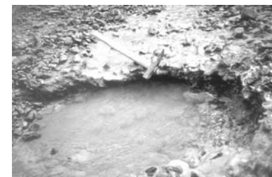
Рис. 4. Частично обезвоженное русло р. Б. Гремячая. Осадки, образующиеся при смешении кислых шахтных стоков и речных вод, цементируют русловую гальку.
