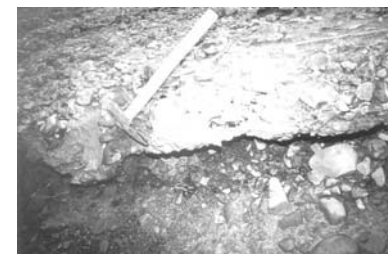
Рис. 5. Полностью обезвоженное ложе и подмытый правый берег реки. Отчетливо видны образованные техногенные конгломераты с гидроксидно-железистым цементом.
