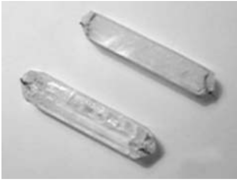
Рис. 1. Монокристаллы \alpha\text{-Si}_x\text{Ge}_{1-x}\text{O}_2 (длина нижнего кристалла 50 мм), выращенные в растворах NaOH (вверху) и \text{NH}_4\text{F} (внизу) при температуре 700^\circ\text{C} и давлении порядка 180 МПа.
