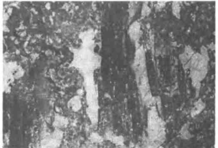
Рис. 8 Доломит-кальцитовый карбонатит с рихтеритом (ув. 1,5х, образец окрашен раствором ализарина в соляной кислоте).
