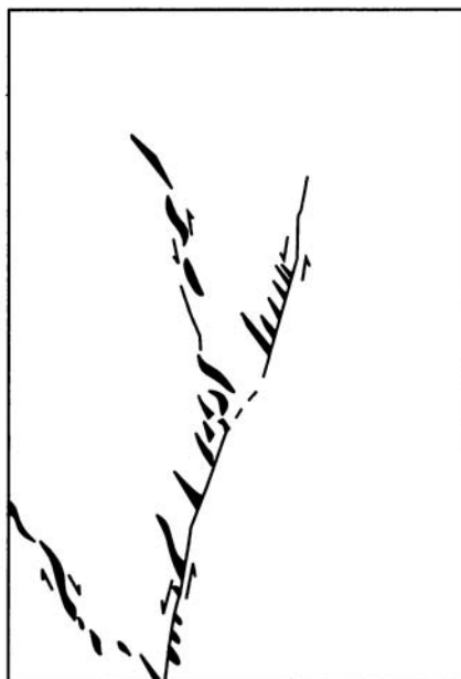
Рис. 26. Кулисно расположенные трещины отрыва (в середине нижней части снимка) и скола (вверху слева) помогают установить знак сдвиговых смещений, балка к западу от с. Александровка (западное крыло Жирновской антиклинали, Доно-Медведицкие дислокации), известняки карбона. Справа – схема дешифрирования
