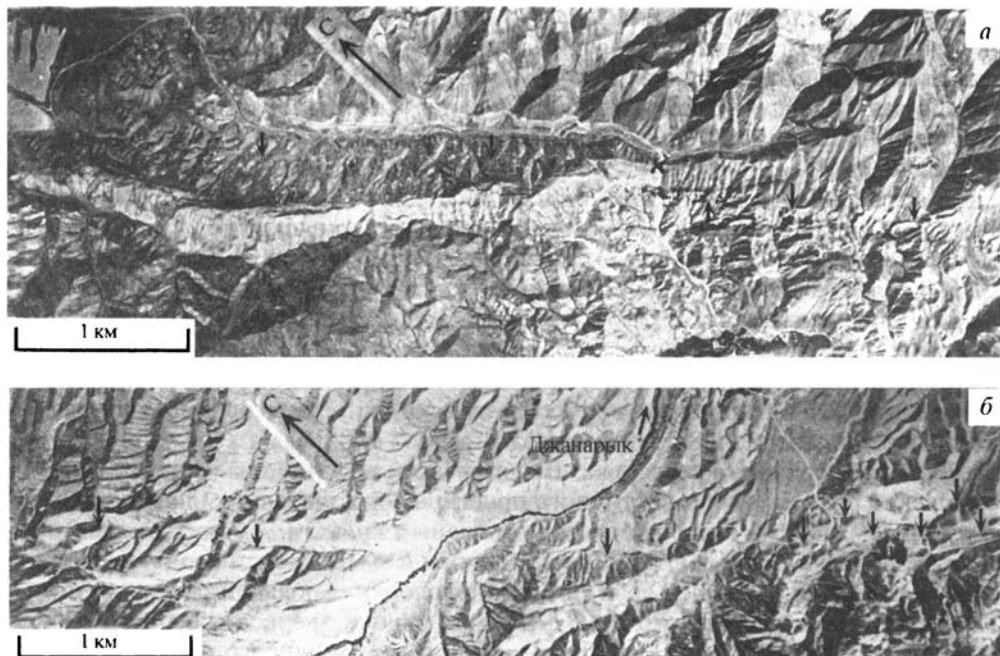
Рис. 12. Позднечетвертичные смещения долин по Таласо-Ферганскому активному сдвигу в Тянь-Шане на аэрофотоснимках [Трифонов и др., 1992]: а – смещения мелких водотоков возле перевала Кокбель (обозначен крестом) и к северо-западу от него; б – правый изгиб на 1,5 км долины р. Джанарыксай
