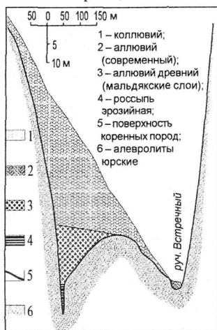
Рис. 15. Пример размещения эрозионной россыпи в разрезе террасовала в долине горного ручья 1-го порядка (руч. Встречный), бассейн верховьев Колымы
