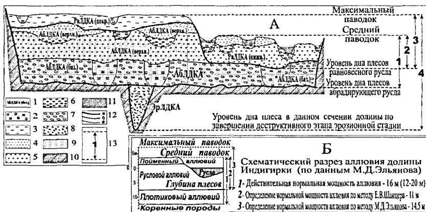
Рис. 3А. Строение нормальной цикловой толщи аллювия в равновесном днище горной речной долины и варианты определения ее мощности. 1 – литодинамические комплексы аллювия (ЛДКА): ЭрЛДКА – эрозионный, АБЛДКА – абразионный (горизонты: баз – базальный и верхн – верхний), РвЛДКА – равновесный (горизонты: нижн – низкой поймы и покр – покровный, высокой поймы); 2–8 – генетические подтипы и фации аллювия: 2 – старичный подтип, 3 – покровный подтип (высокой поймы), 4 – пойменный подтип (низкой поймы), 5 – береговые литофации, 6 – русловые литофации равновесного ЛДКА, 7 – стрежневая литофация, 8 – эрозионная литофация; 9 – абразионный ЛДКА; 10 – коренные породы; 11 – меженное русло, протоки, старцы; 12 – границы: ЛДКА (а), горизонтов (б), подтипов и литофаций аллювия (в); 13 – границы нормальной мощности аллювия, определяемые исследователями: 1 [Карташов, 1960, 1972], 2 [Шанцер, 1951] (по И. П. Карташову), 3 [Эльянов, 1958] (по И. П. Карташову), 4 предлагаемый вариант. Б. Копия рисунка 1 из статьи: [Карташов, 1960. С. 118]
