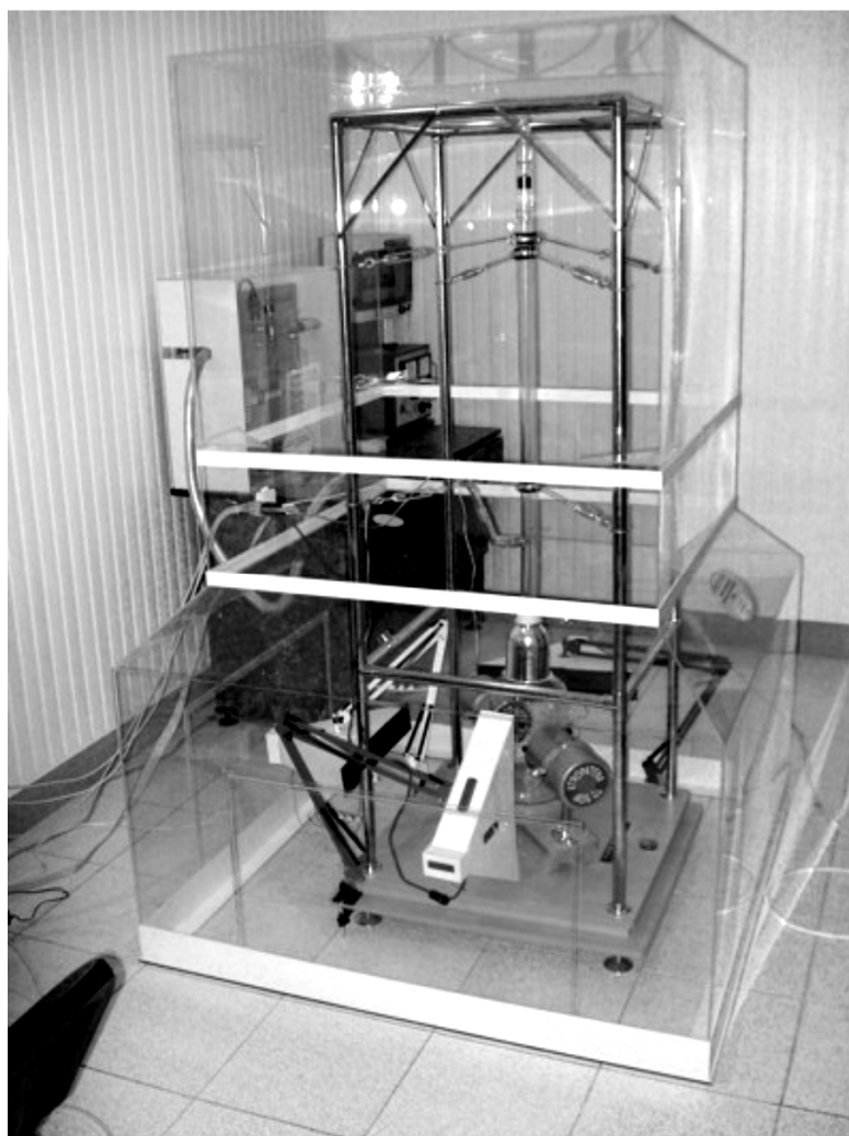
Рис. 53. Фотография Торсионного Детектора Длиннопериодных Гравитационных Вариаций (ТД ДГВ - АТРОПАТЕНА), расположенного на станции прогнозирования землетрясений НИИ прогнозирования и изучения землетрясений (г. Баку).
