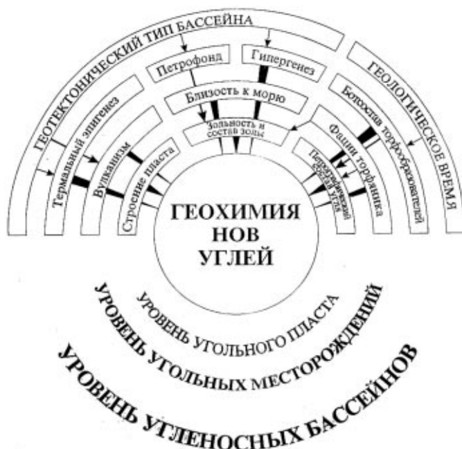
Рис. 2. Факторная схема геохимии углей
