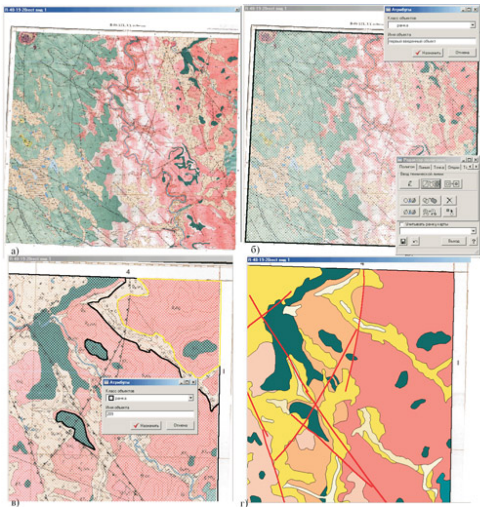
Рис. 3. Создание цифровой векторной модели карты по растровой подложке: а) растровая подложка; б) ввод начального объекта, соответствующего рамке карты; в) «разрезание» начального объекта, присвоение атрибутивной информации; г) построенная цифровая модель карты
