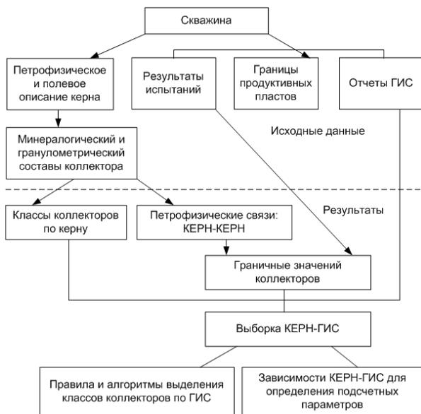
Рис. 2.7. Технологическая схема петрофизического обоснования для расчета подсчетных параметров в системе ГЕММА
