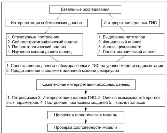
Рис. 2.6. Технологическая схема построения модели резервуара (по С.Б. Денисову)
