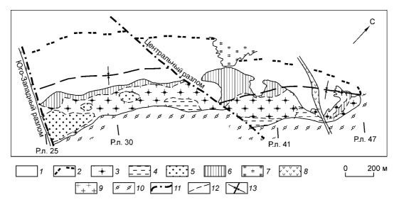
Рис. 6. Проекция на горизонтальную плоскость сидеритовой залежи № 3 на Озерном месторождении (по данным Удино-Витимской ГРЭ, 1969).
