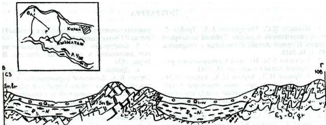
Рис. 2. Схематический геологический разрез антиклинальной структуры Центрально-Курайской гряды в западной части Курайской впадины.
