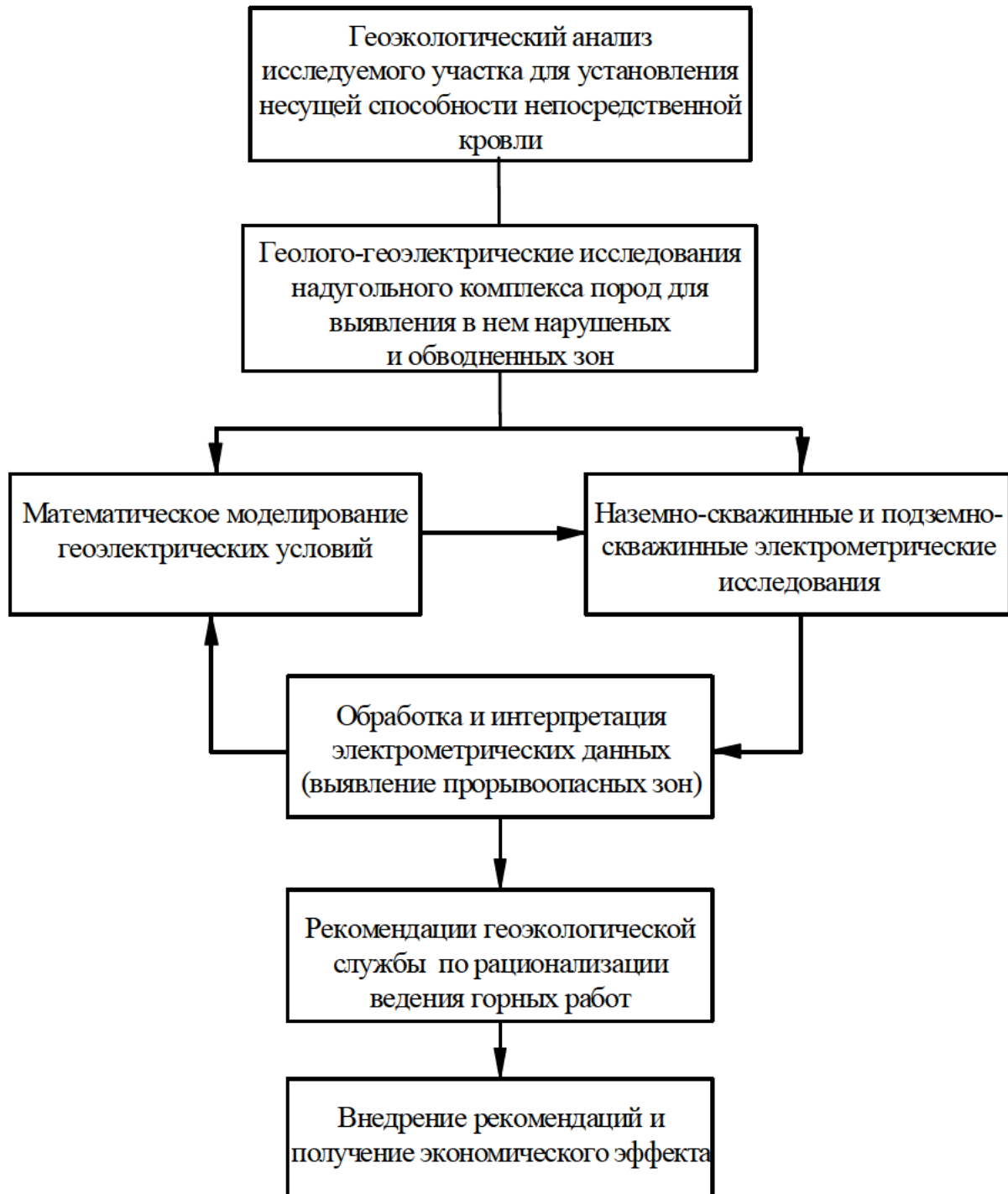
Структурная схема прогнозирования рационального ведения горных работ по данным геозекологических и геоэлектрических исследований углевмещающих пород
