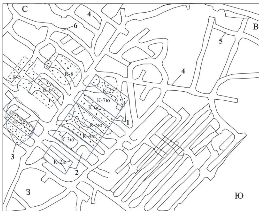
Рис. 1. Расположение камер в блоке 5 б на горизонте 4. 1 – камеры с закладкой; 2 – камеры без закладки; 3 – обрушение горных пород; 4 – штрек; 5 – орт; 6 – наклонный заезд
