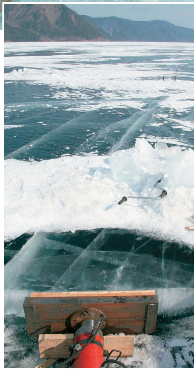
Сотрудниками Института земной коры СО РАН (г. Иркутск) и Института физики прочности и материаловедения СО РАН (г. Томск) на ледовом полигоне Байкала ведутся многолетние исследования по моделированию сейсмических процессов с целью разработки технологий управления землетрясениями
