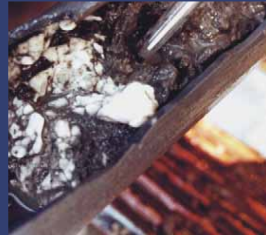
Газогидраты в грунтовых пробах выглядят как непрозрачные включения двух типов: крупные массивные комки с тонкими трещинами, заполненными осадком, и многочисленные более мелкие включения плитчатой формы, размером до 2 см. По данным газохроматографии, в составе газогидратов 99 % метана. Фото Я. Клеркса
