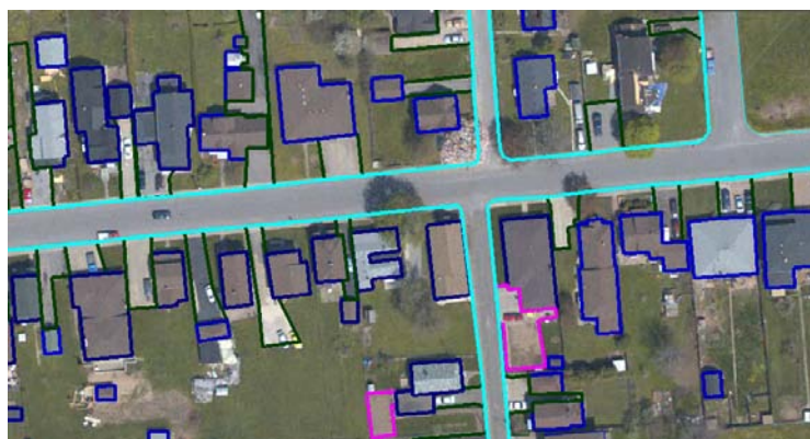
Рис. 4. Фрагмент векторизованных объектов по ортофотоплану (г. Ниагара-Фолс)
