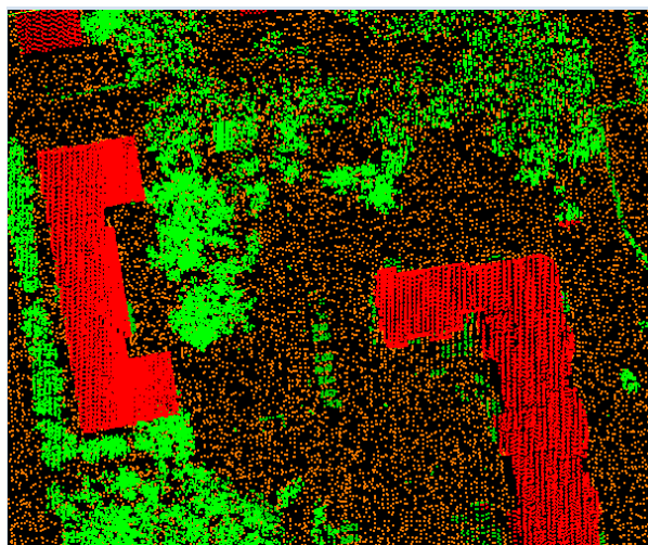
Рис. 7. Фрагмент классифицированных данных воздушного лазерного сканирования г. Омска
