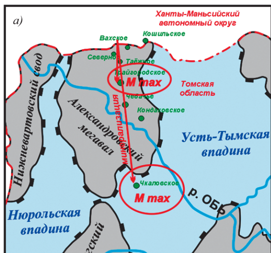
Рис. 2. Изменение минерализации подземных вод кровли доюрского фундамента юго-восточного склона Александровского мегавала: а) карта направления увеличения минерализации по территории; б) график изменения минерализации с глубиной.
