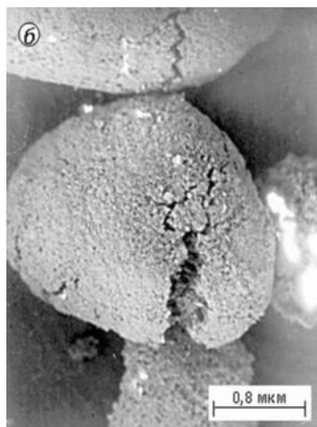
Рис. 3. Оолиты из фильтров, проработавших: а — 10 лет; б — 20 лет. Водозабор Академгородка
