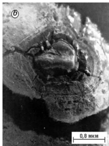
Рис. 4. Концентрически-слоистое строение оолитов из фильтров водозаборов: а — Академгородка; б — Томска
